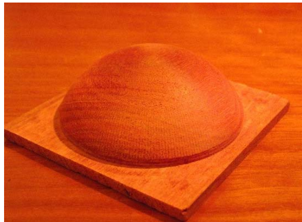
Aspect d'une surface sphérique dans une poche vidée
